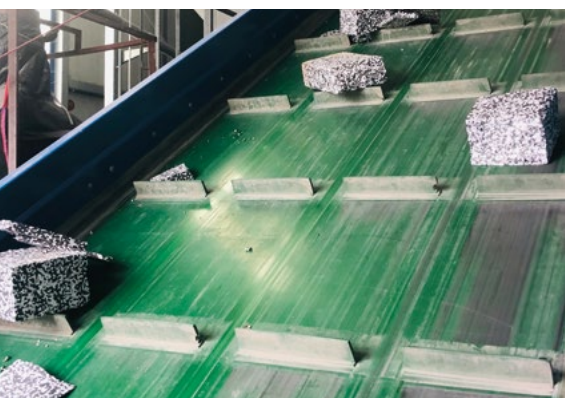
▲ EPS-Abschnitte werden sortiert geschreddert
