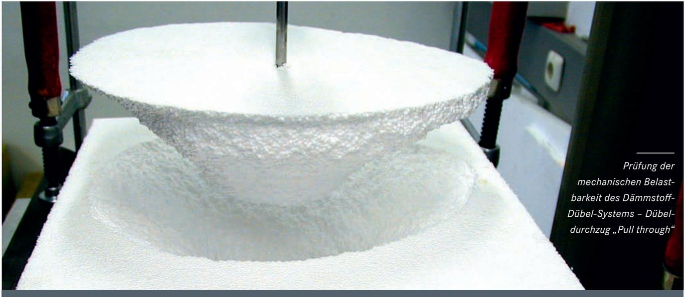
*Prüfung der mechanischen Belastbarkeit des Dämmstoff-Dübel-Systems – Dübel-durchzug „Pull through“*
