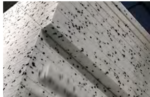
▲ Kantenbearbeitung: Stufenfalten und Nut & Feder werden gefräst. Bearbeitungsreste werden der Wiederverwertung zugeführt. Die hier zu sehenden grau gefärbten Anteile in der EPS-Platte sind durch Rezyklat-Zugaben entstanden.
